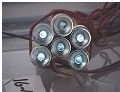
Fig. 12. (B) Grupo de LEDS iluminados con celdillas.
