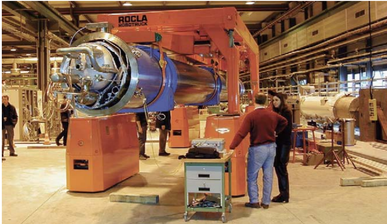
Para el transporte cuidadoso de los imanes dipolares del LHC fue construido expresamente un robot, llamado 'el cangrejo'.
