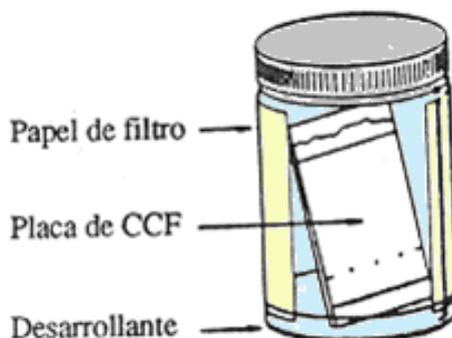
**Figura 24.** Esquema de cromatografía en capa fina
