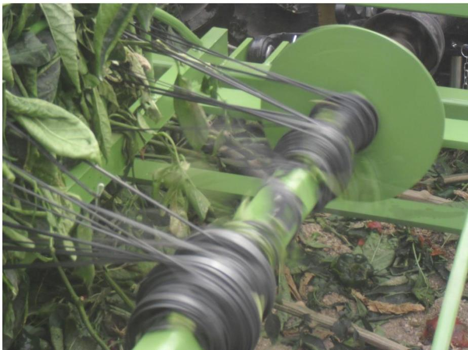
**Fotografía 1.** Máquina bobinadora retirando hilo de rafia de un cultivo de pimiento
