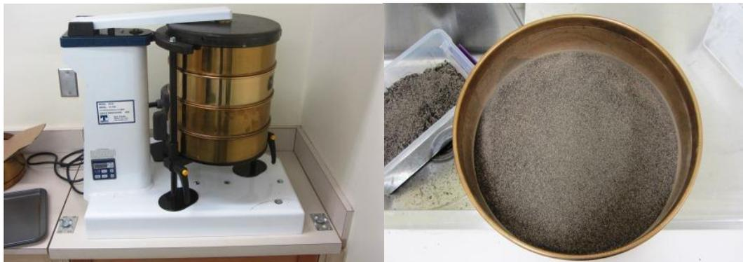
**Figura 1.** Tamizado del suelo antes de proceder a la separación de los AH. (fotos: D. Olivera)
