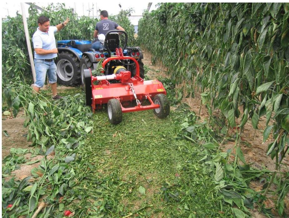
**Fotografía 2.** Tras retirar la rafia y los ganchos de entutorado se procede al picado. En este caso se ha empleado una picadora de martillos.
